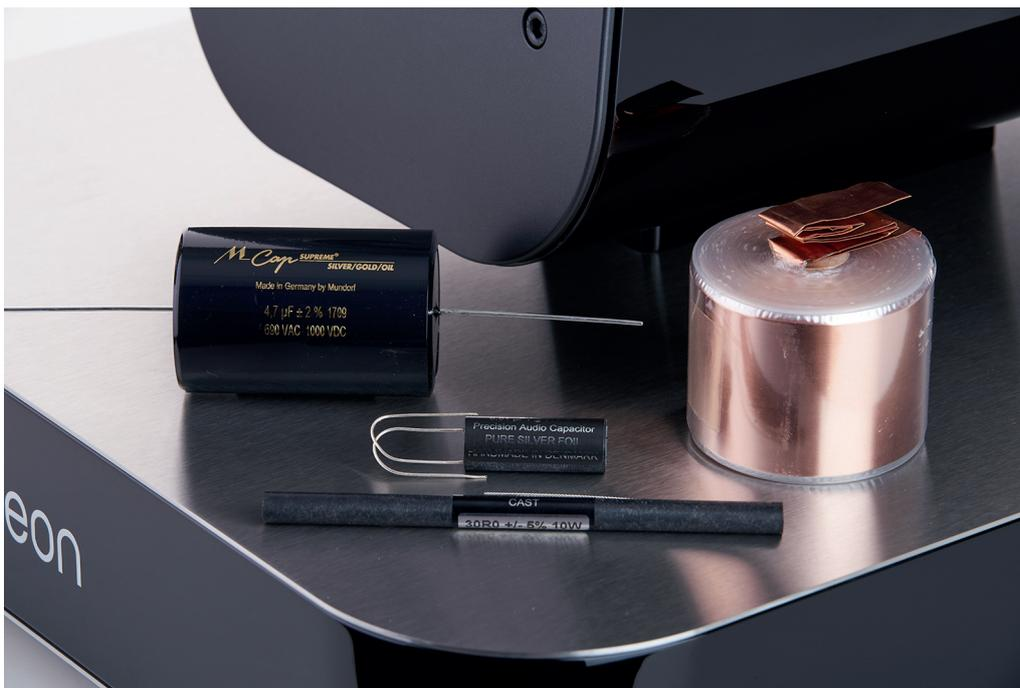
*Die Weiche können wir nicht zeigen, wohl aber die dort verbauten exquisiten Bauteile: Kondensatoren und Spulen von Mundorf, Widerstände und Silberfolien-Kondensatoren von Duelund*
